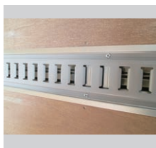
㉜ラッシングレール埋込
