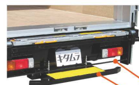
引き出し式乗降ステップ 安全バー ※黄色のスベリ止めテープはオプションです。
